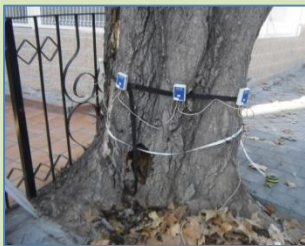
Imágenes de testificación realizada en un árbol con tomógrafo sónico y del tomograma obtenido.
